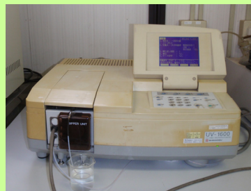
吸光光度法（分光光度計）によるイオン濃度測定状況
